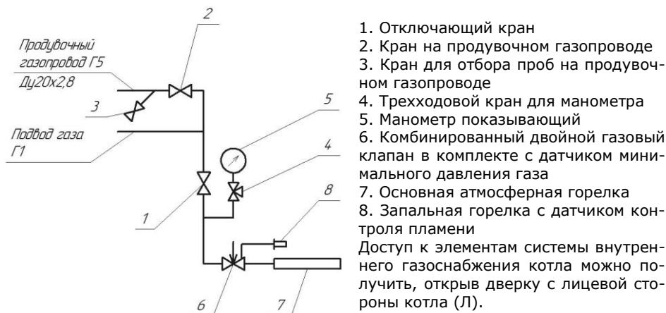
Схема внутренних газопроводов котла
