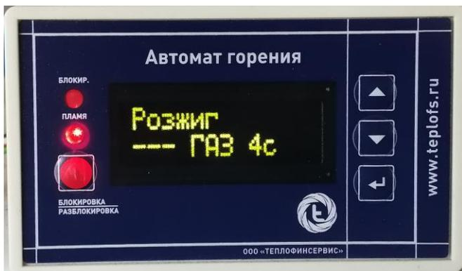
На случай не удачной попытки розжига или погасания пламени запальника в момент розжига, автомат горения имеет функцию повторного пуска, после трёх не удачных попыток котёл уходит в аварию, на экране отображается надпись «Нет пламени»
